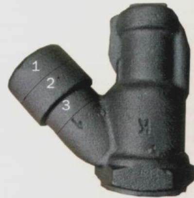
Рис. 3. Расположение колец, вырезанных из отливки при исследовании однородности и определении C_f
