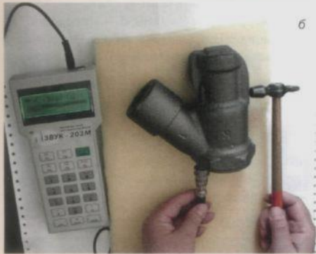
Рис. 2. Измерение ЧСК типа f_1 с внутренним микрофоном (а), с внешним приемником (б)
